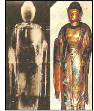
* 仏像を壊さずに内部を調査
