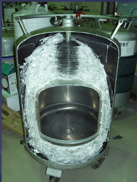
液体ヘリウム容器の 内部構造
