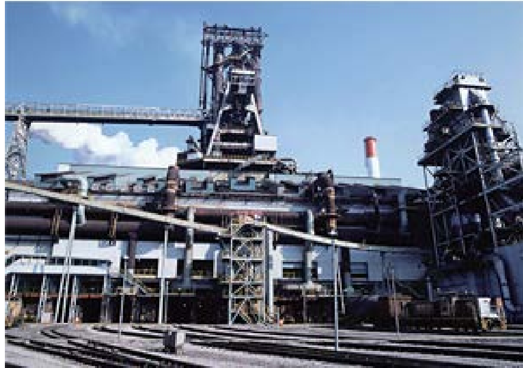
現在の高炉(八幡製鉄所) 高炉1基あたりの生産 約1万トン/日
