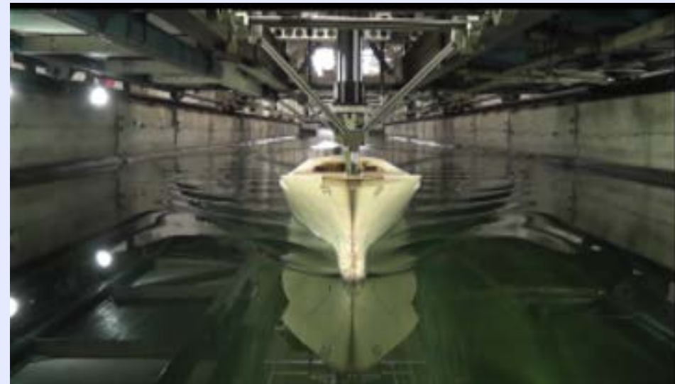
工学部船型試験水槽
