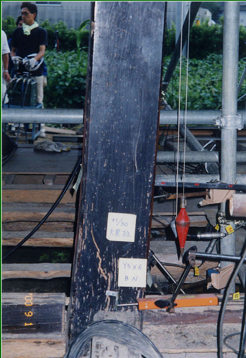
大黒柱・柱脚の曲げ破壊 1/30rad. 柱頭のせん断破壊 1/20rad.
