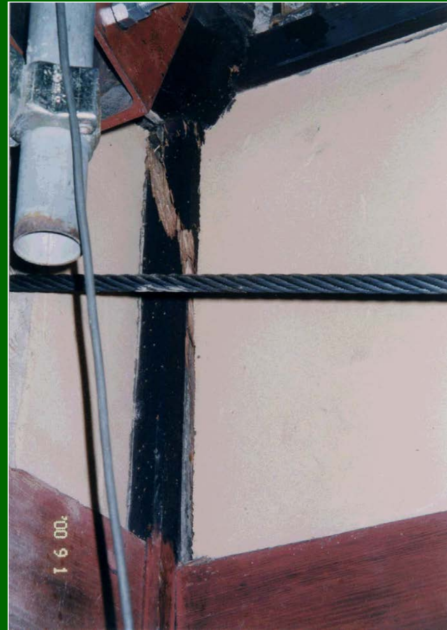
大黒柱・柱脚の曲げ破壊 1/30rad. 柱頭のせん断破壊 1/20rad.
