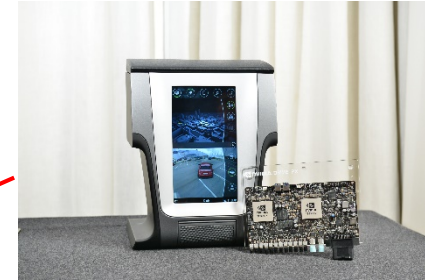
車載コンピューター
