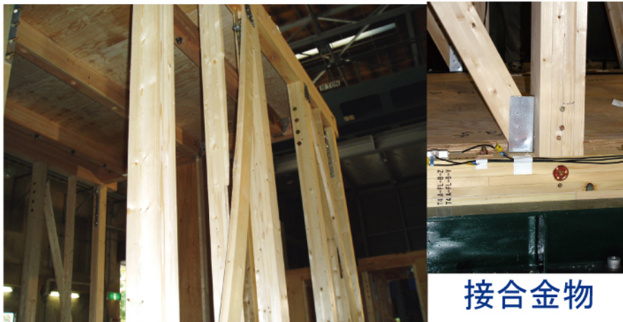
圧縮筋違の座屈による面外変形
