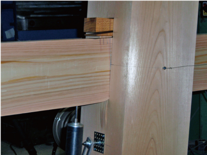
貫架構仕口の終局時変形モード
