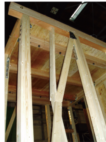
座屈曲げ破断
