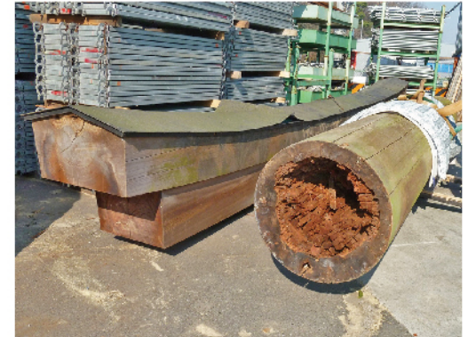
大鳥居の掘立て柱脚部の腐食 瀧川寺社建築
