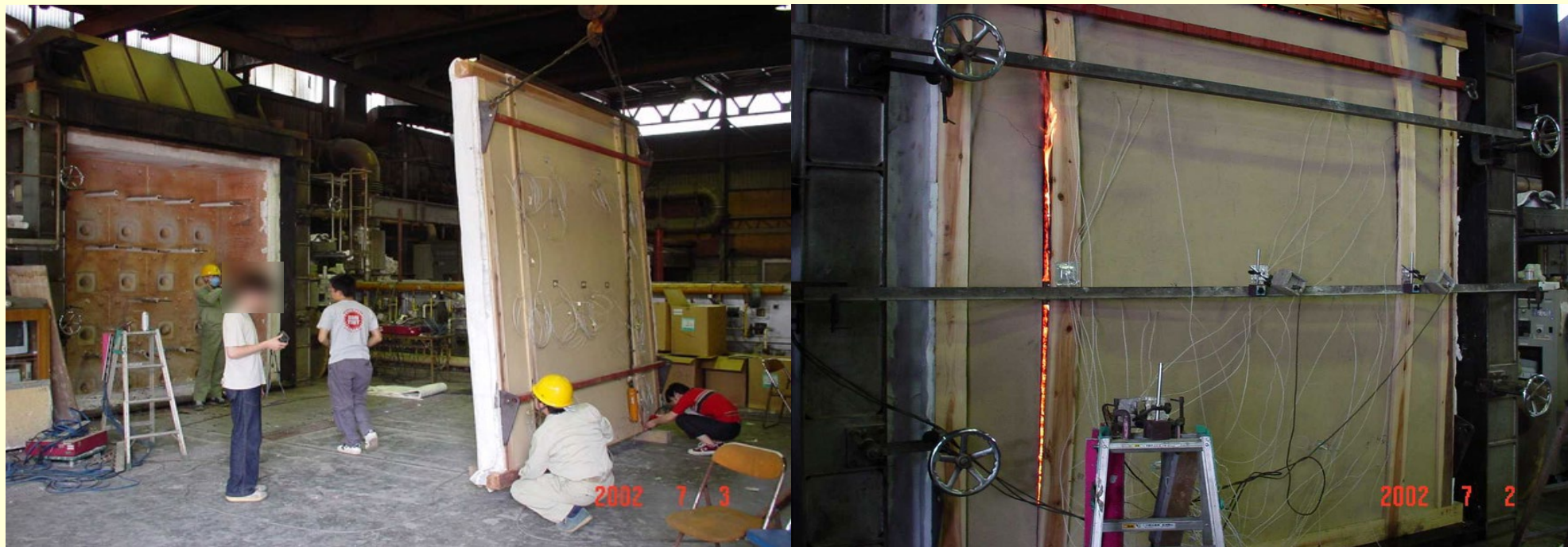
耐火炉と土壁試験体
